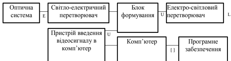
Рис.8.1 Узагальнена структура телевізійного засобу вимірювання
