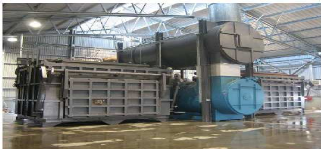
Рис. 2. Система порційної термічної переробки органічних відходів
