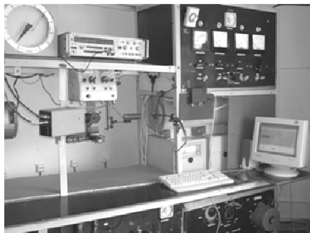
Рис. 1. Общий вид экспериментальной установки по определению воспламеняемости неподвижной (подвешенной) капли горючей жидкости в потоке воздуха
