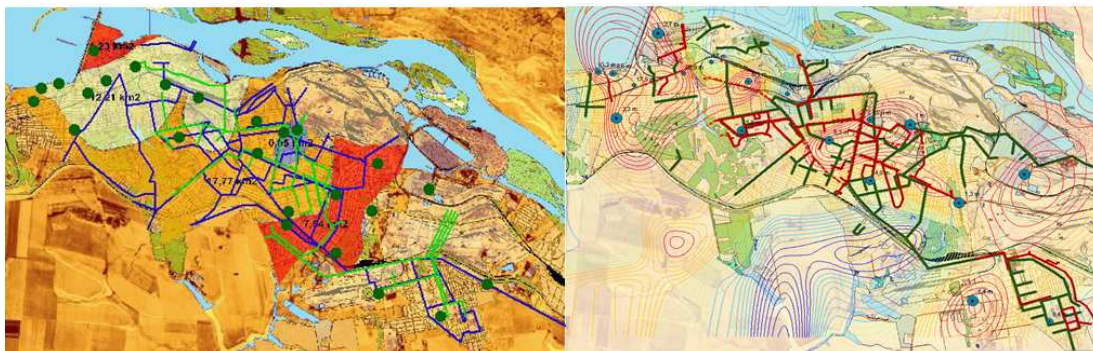
Рис. 3. Електронна карта мереж водопостачання, водовідведення та мереж зливової каналізації, свердловин режимного спостереження за РПВ м. Дніпродзержинська
