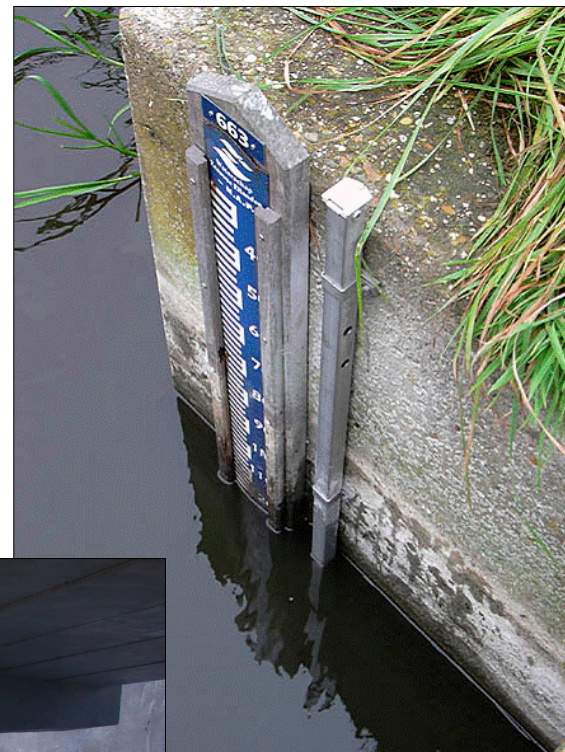
Електронний самописець рівня та температури поверхневих вод поруч із мірною рейкою рівня води
