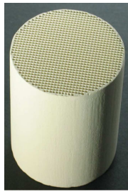
Рисунок 4 – Примеры матриц регенераторов термоакустических аппаратов
