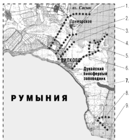
Рис. 1. Варианты трассы глубоководного судового хода (ГСХ) Дунай – Черное море 1. Дунай – лиман Сасык, 2. вариант инж. Чеховича, 3. Соломонов рукав – Жебриянская бухта, 4. рукав Прорва, 5. Соединительный канал порта Усть-Дунайск, 6. Очаковский рукав – база порта Усть-Дунайск, 7. рукав Быстрый, 8. рукав Цыганка, 9. рукав Старостамбульский
